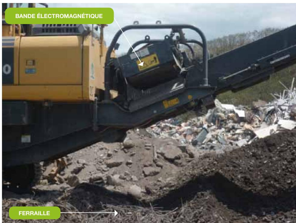
**Figure 7 :** Déférailleur électromagnétique (source STS)
