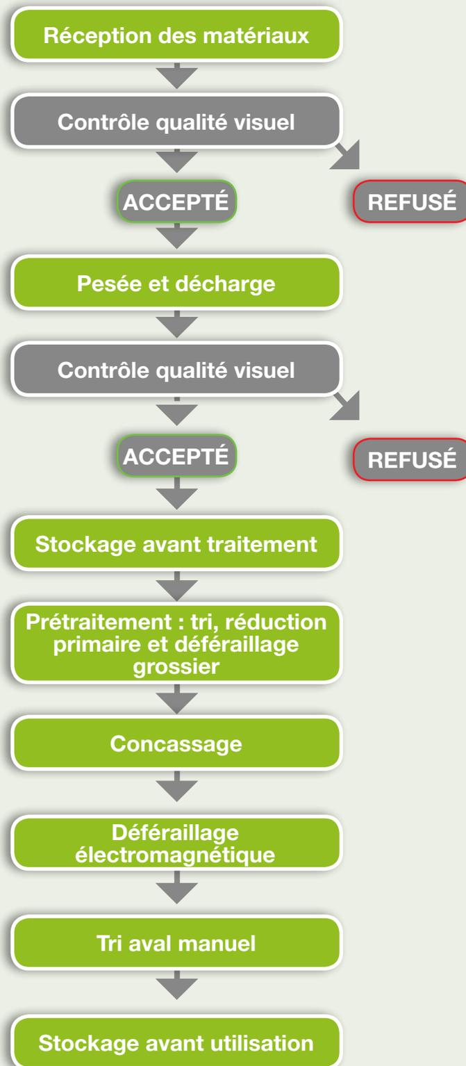
Figure 9 : Schéma synoptique de production de graves recyclés
