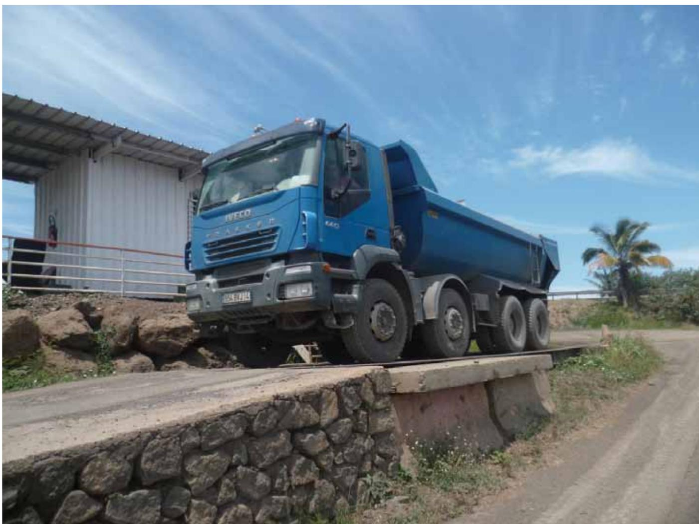
**Figure 2 :** Pesée du camion entrant (source STS)
