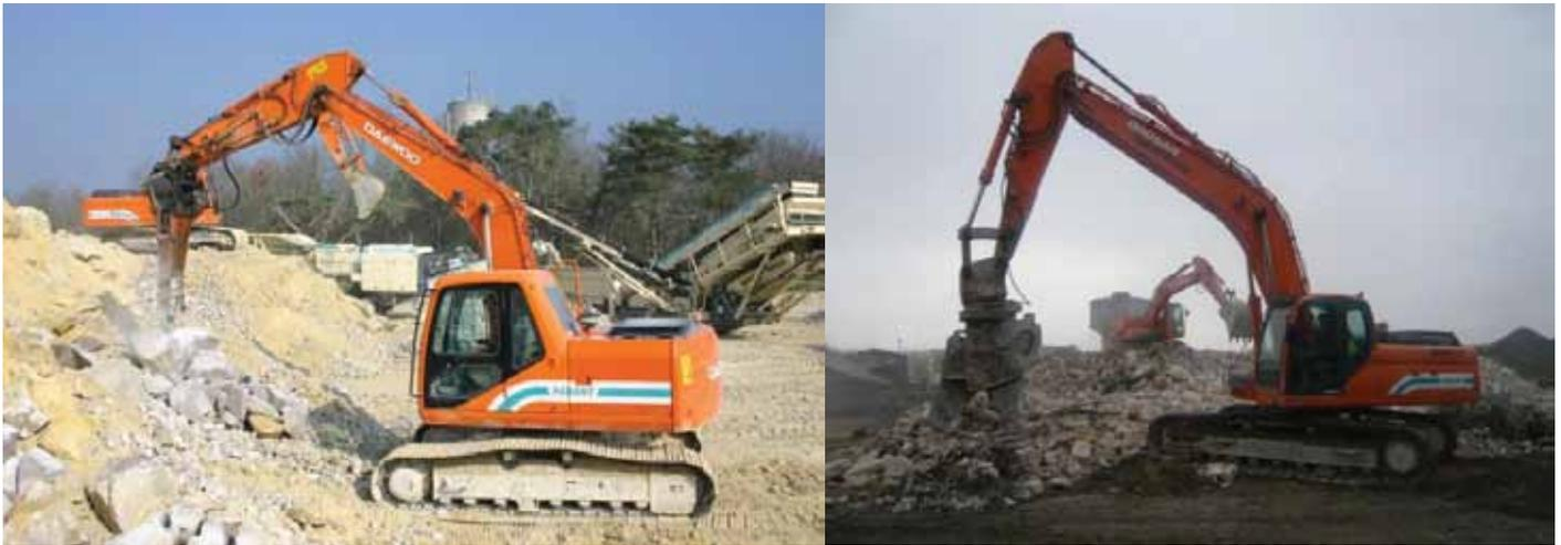
**Figure 5 :** Brise roche hydraulique à gauche et pince béton à droite (source T.Girods)
