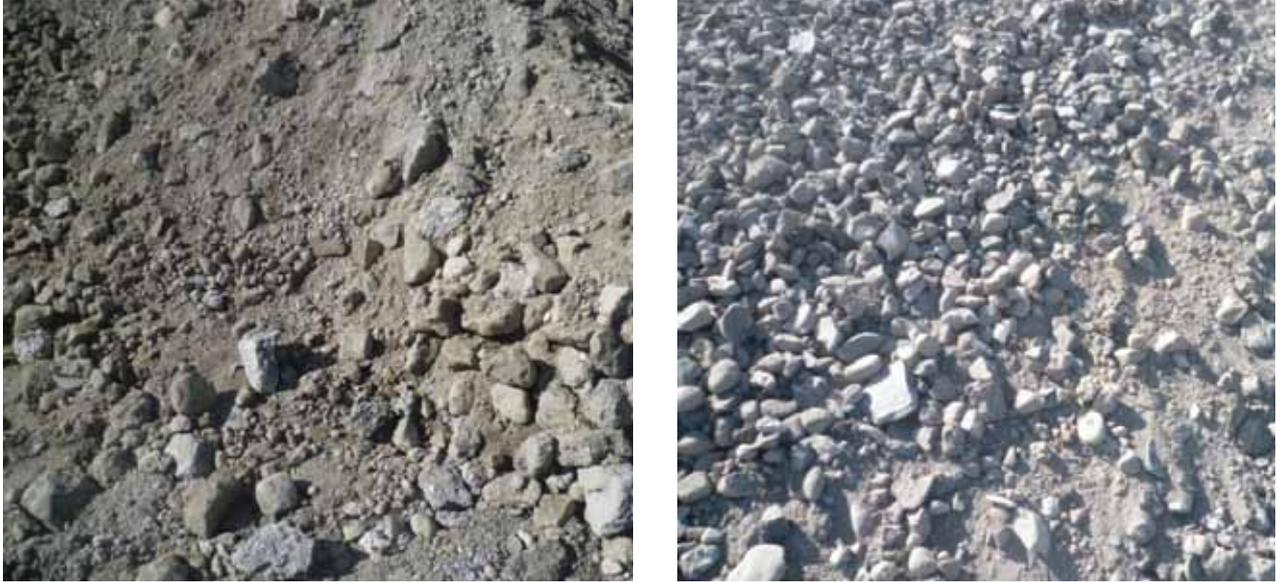
**Figure 10 :** Aspect du produit final 0/80mm (source LAFARGE et SCPR)
