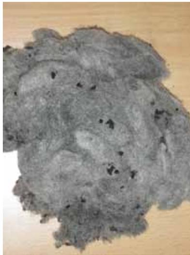
*Figure 19 : Bourre de textile issues du recyclage de pneumatiques (source Solyval)*
